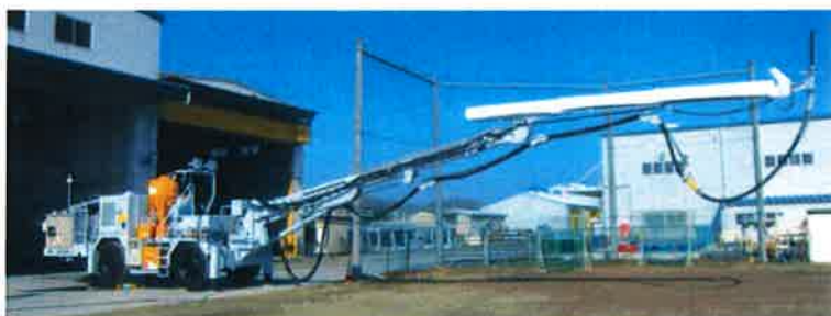
写真-1 ロングブーム吹付け機
