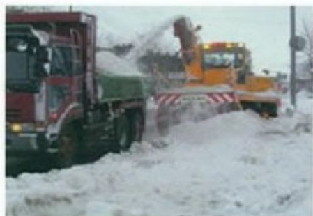
【拡幅除雪】2.6m、220kw
