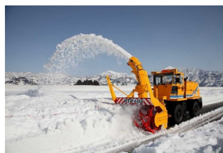
【拡幅除雪】2.6m、290kw
