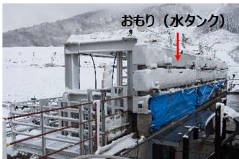
写真-4 おもり台車（上：全景、下：設置状況）
