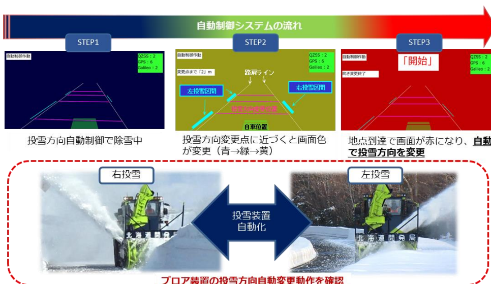
図-10 ブロー装置の投雪方向自動制御
