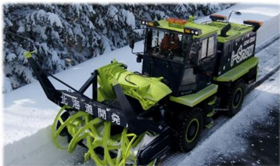
図-5 i-Snow仕様ロータリ除雪車の外観
