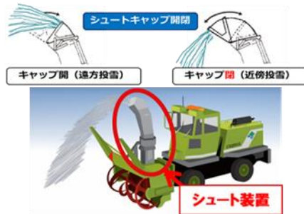
図-11 シュート装置及びシュートキャップの開閉
