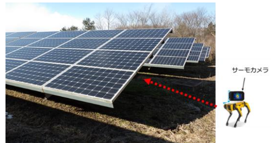
図-4 メガソーラー施設の巡回・点検
