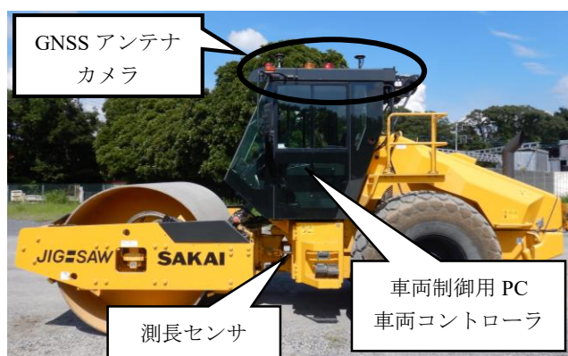
写真-1 自律走行式ローラと主な改造項目
