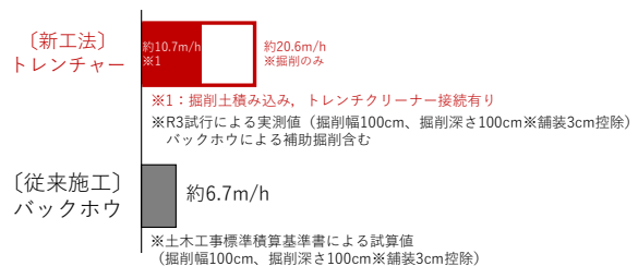
図-7 施工速度の比較（歩道部）
