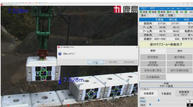
写真-8 操作画面(据付動作中)
