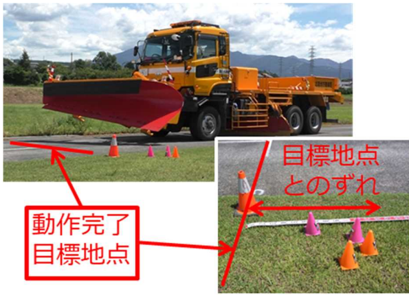
写真-4 自動制御動作精度の確認状況
