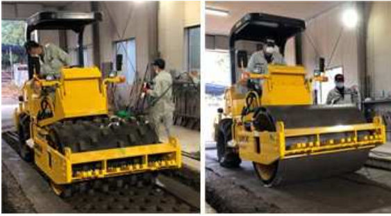
写真-1 締固め試験状況 (左: SVT-5t, 右: SVF-5T)
