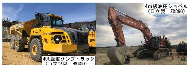
写真-3, 4 設置対象の重機
