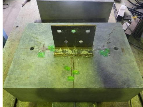
写真-2 引抜試験後の供試体 (BASE01)
