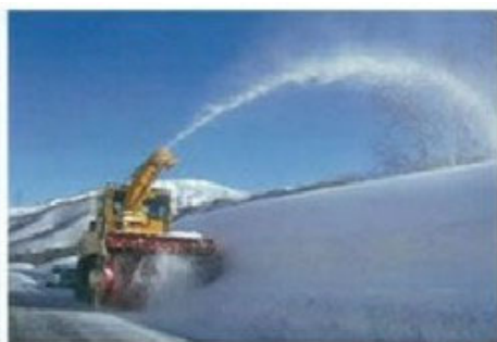
【拡幅除雪：高雪堤処理付】220kw 級
