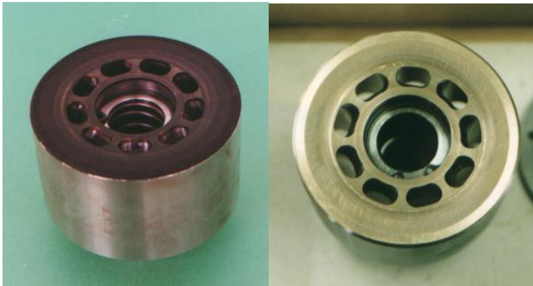
付図1 シリンダブロック球面部の腐食の例 (左図：腐食深さ 1\mu\text{m} 以上で不合格、右図：腐食なし合格)
