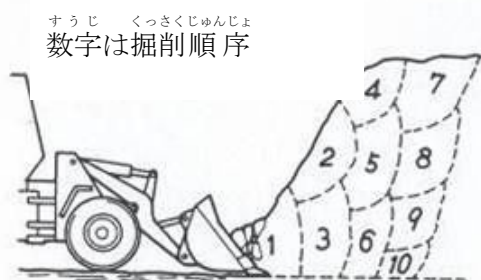
山の掘削作業
