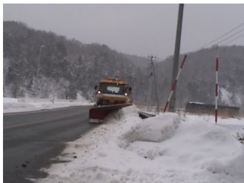
写真 投雪制御装置による除雪作業
