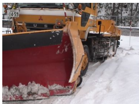
写真 投雪制御装置
