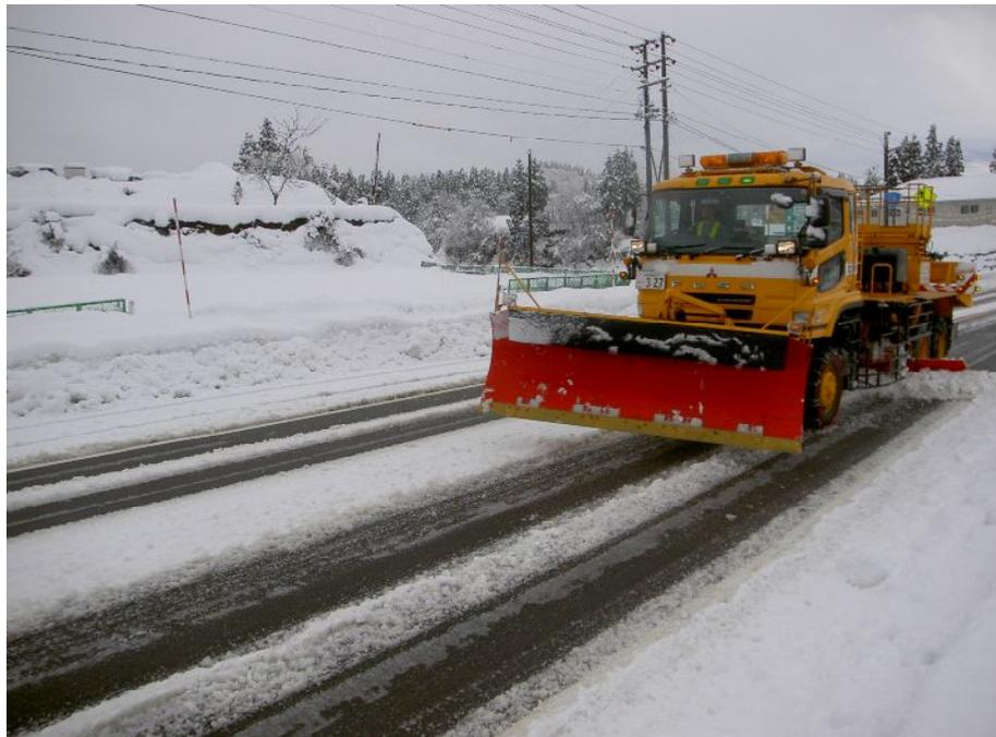
写真 トラックグレーダによる圧雪除去作業
