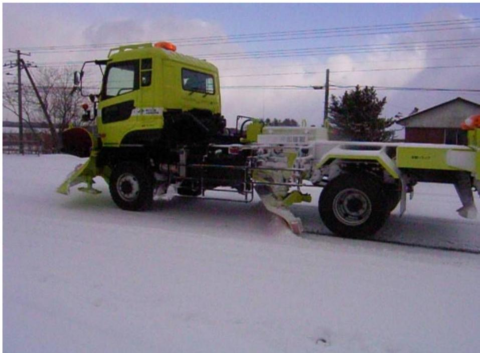
写真 トラックグレーダによる圧雪除去作業(側面から)
