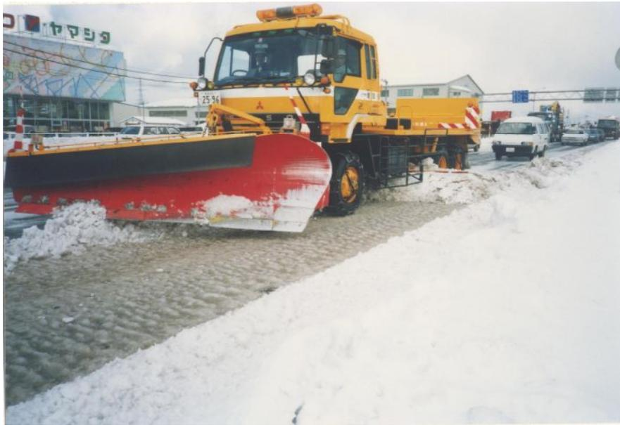
写真 整正幅可変ブレードによる道路除雪作業
