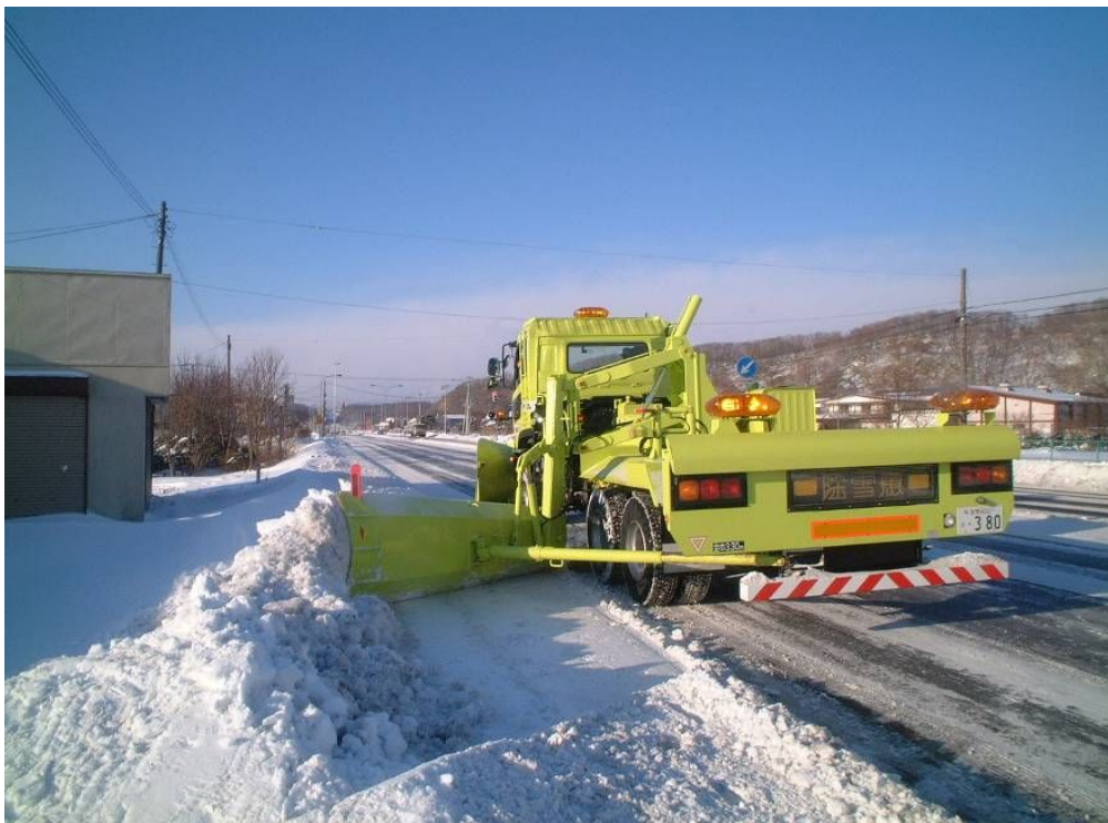
写真 サイドウイング装置による拡幅除雪作業(後方から)
