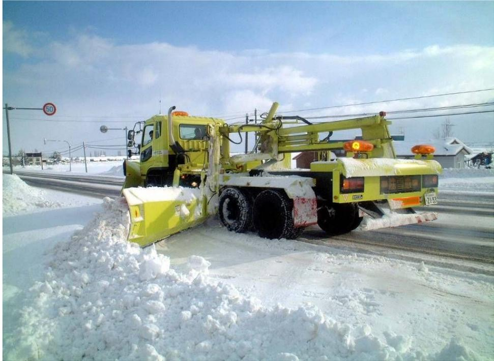
写真 サイドウイングマックレー装置によるサイドウイング作業
