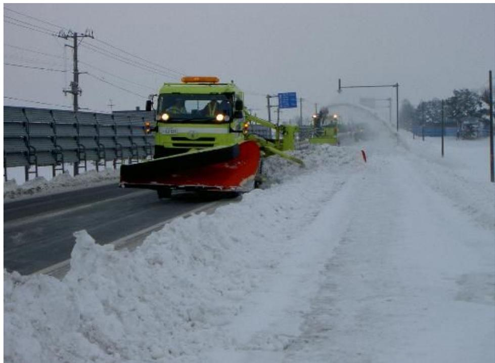
写真 サイドウイングマックレー装置によるマックレー作業
