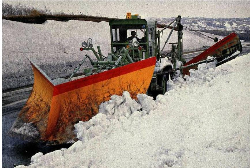
写真 Vプラウを使用した除雪作業
