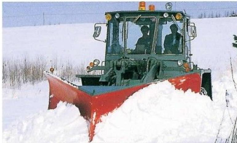
写真 Vプラウによる除雪作業中
