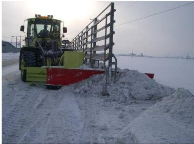
写真 スライドアングリングプラウによる防雪柵の除雪作業
