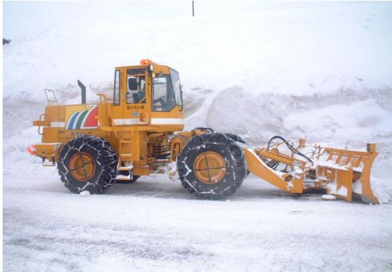
写真 スライドアングリングプラウによる拡幅除雪作業
