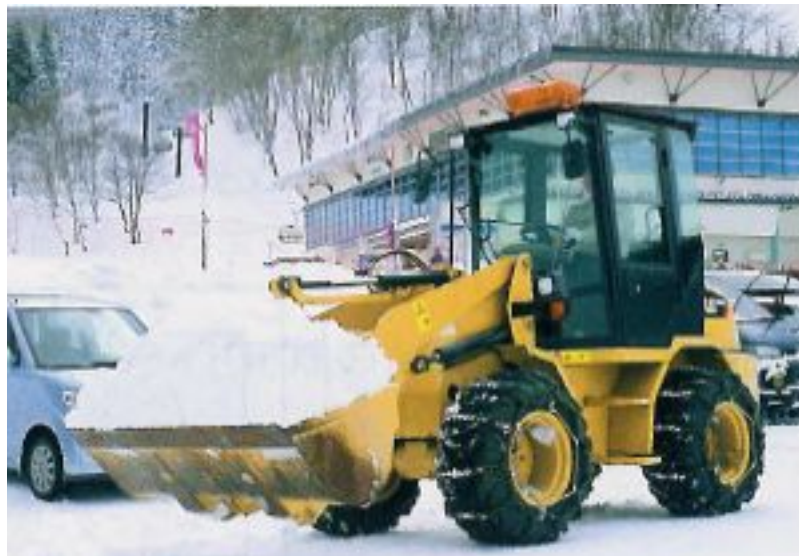
写真 スノープラウによる運搬排雪作業
