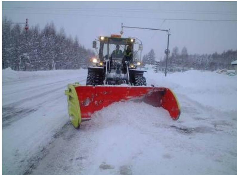
写真 両サイドシャッターによる道路除雪作業中
