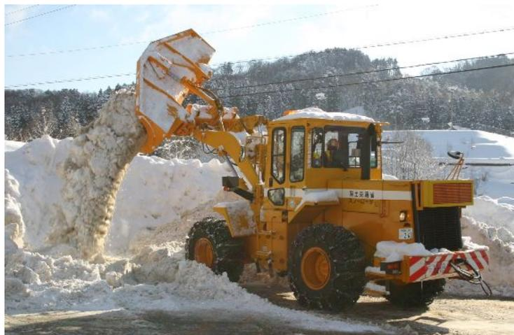
写真 駐車場で両サイドダンプバケットによる除雪作業(後面から見たところ)
