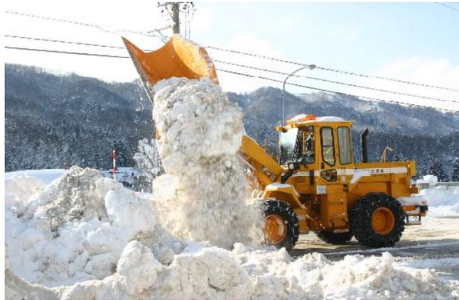
写真 駐車場で両サイドダンプバケットによる除雪作業(側面から見たところ)
