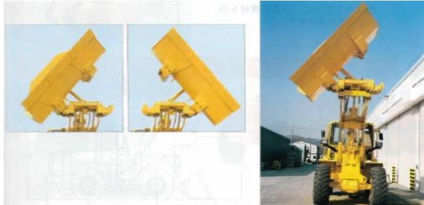
写真 両サイドダンプバケット作業姿勢(左から左へダンプ、右へダンプ)及び全景
