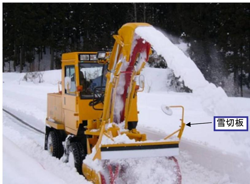
写真 雪切板を使用した歩道除雪作業
