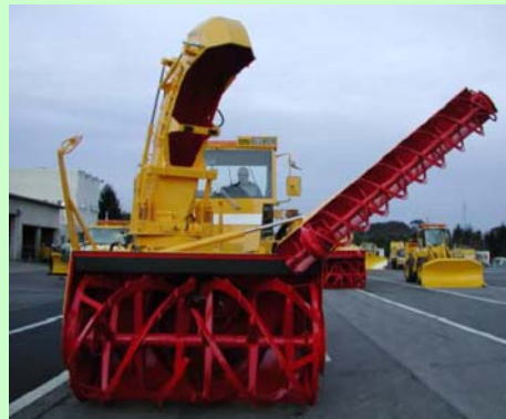
図R-8 高雪堤処理装置
