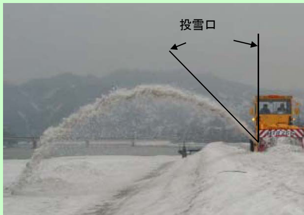
図R-17 投雪口傾斜角度
