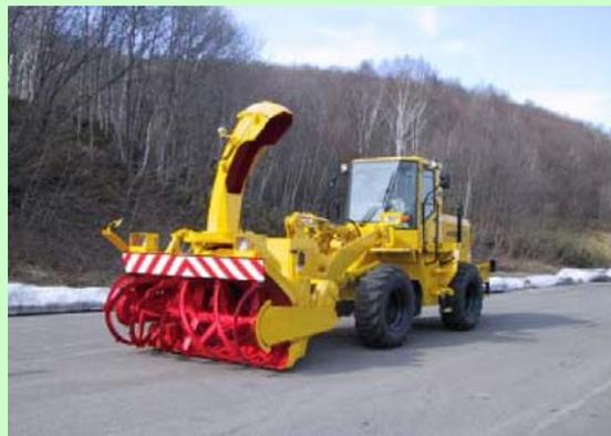
図R-26 ユニット形ロータリ除雪装置
