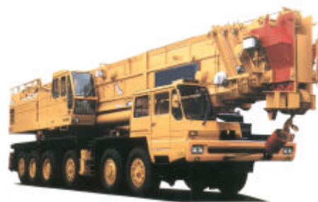
写真 2.3.2 大型オールテレーンクレーン
