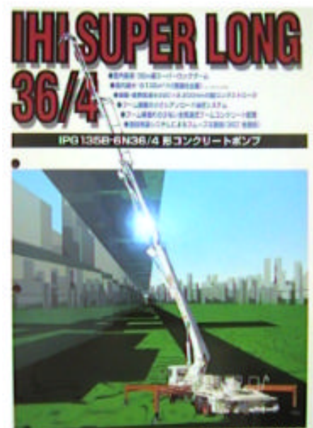
写真 2.6.4 ブーム付コンクリートポンプ車
