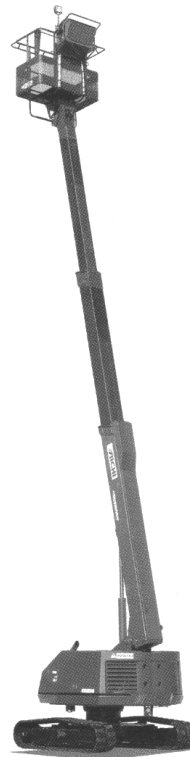
写真 2.7.10 クローラ式高所作業車
