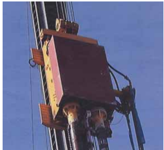
写真 6.1-2 S MW減速機カバー
