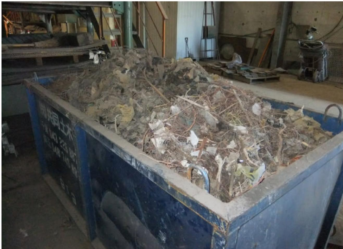
再生路盤材から回収されたゴミ(不純物)
