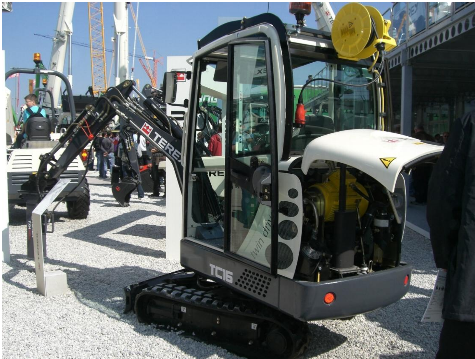
TEREX TC16 ディーゼルエンジンと電気モータを搭載し、 “Twin Drive”としてトンネル工事等に主に使われる。
