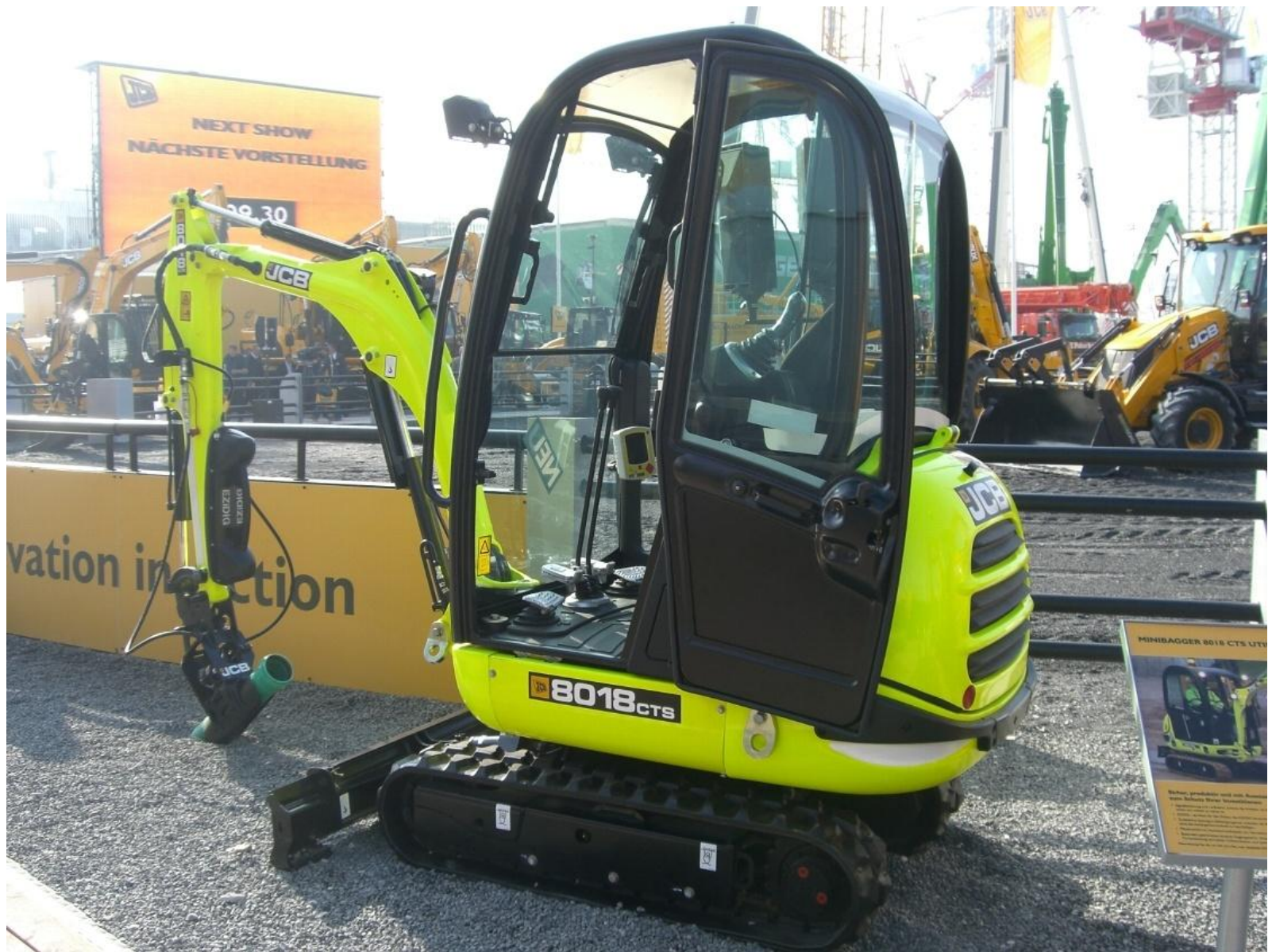
JCB 8018CTS 蛍光色で塗装し、輸送時の固定フック穴を旋回フレームとスイングブラケット側面に設けている。
