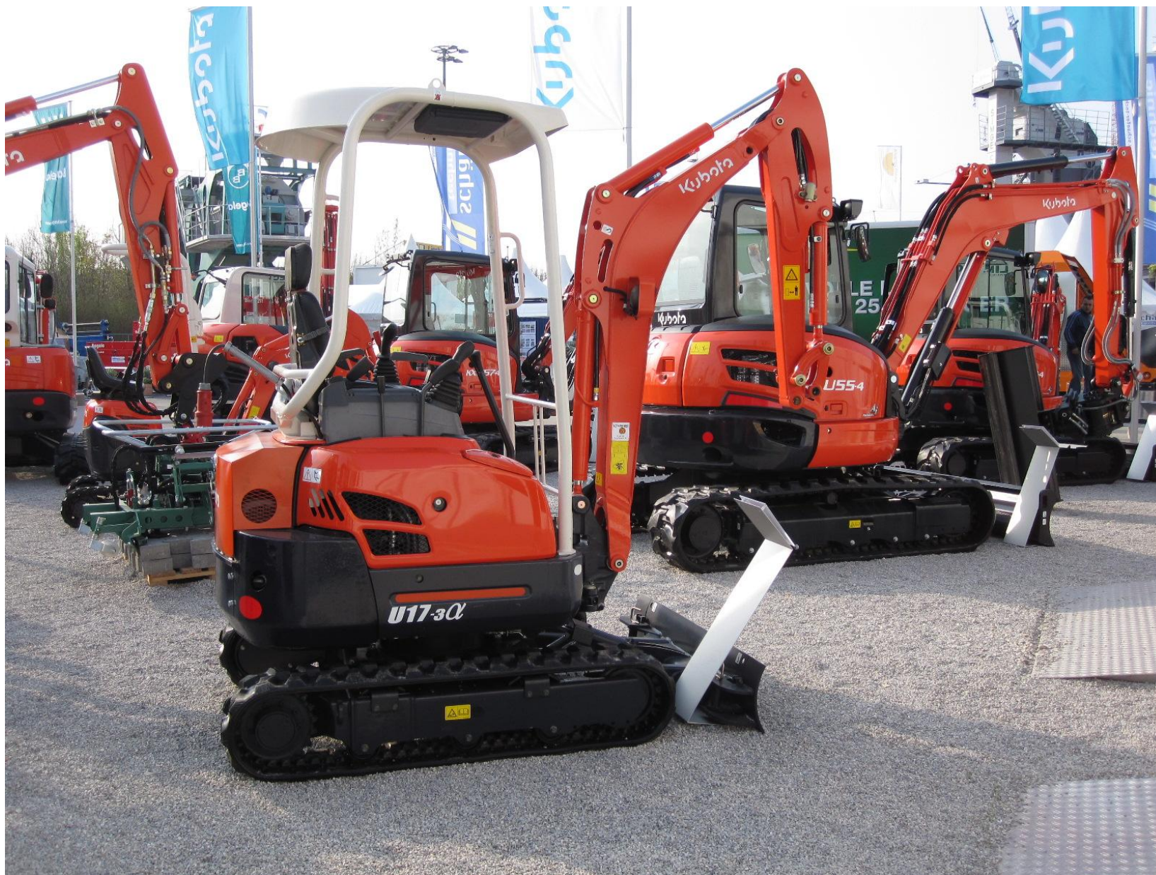
1. 7t機 U17-3α電動仕様。欧州販社で改造を行ってエンジンルーム後方に電動モーターを搭載し、電気でも動かせるようにしている。
