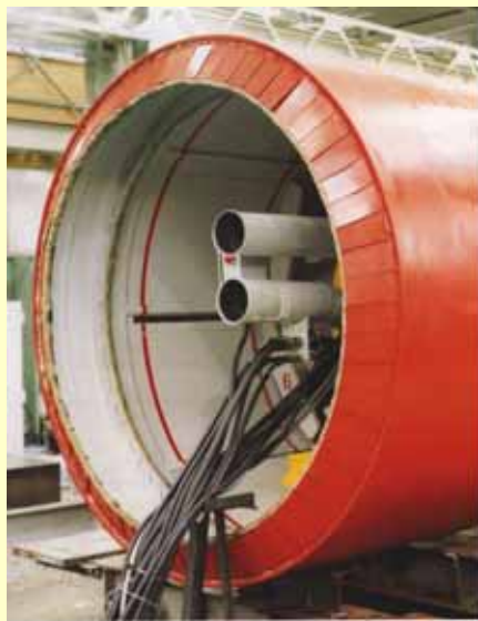
▲ ウレコンシールの取付状況
