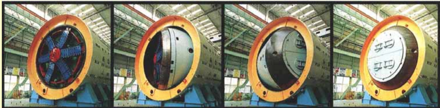
カッタヘッド回転状況
