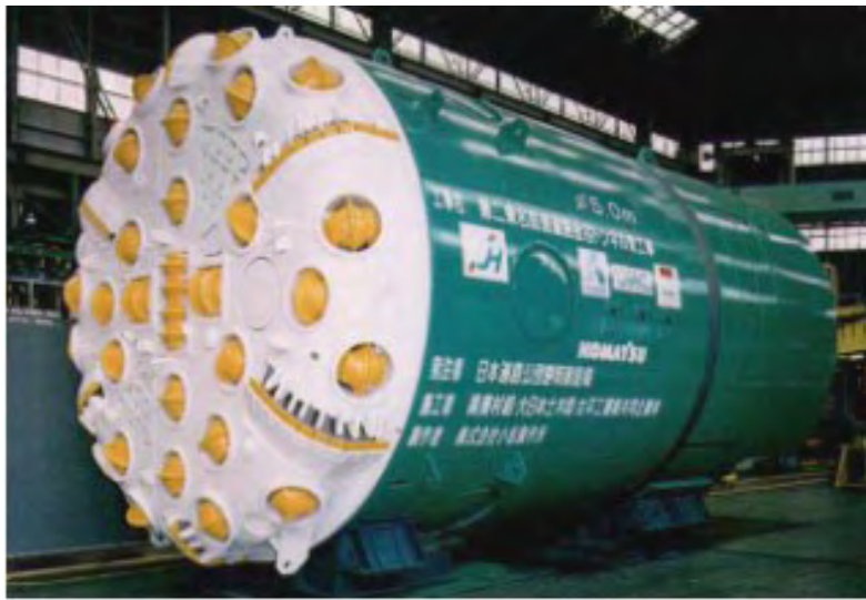
本システムを適用したTBM (第二東名金谷トンネル東工事)
