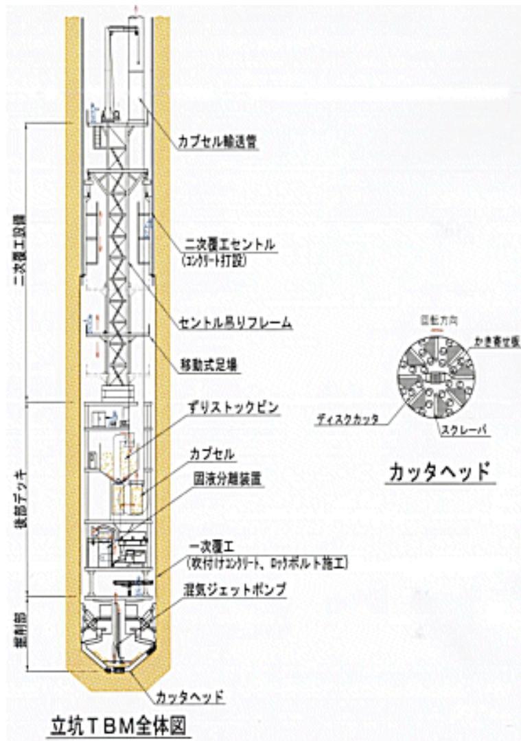
立坑TBM概要図
