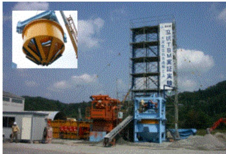
立坑TBM実証実験装置
