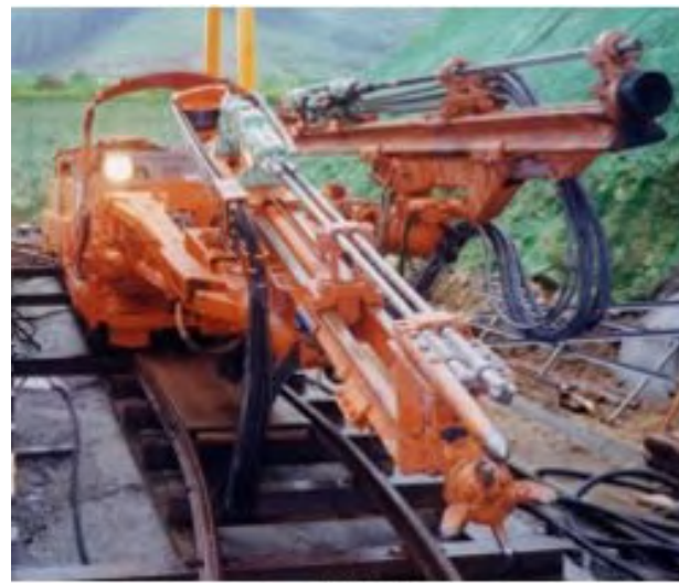
スロットスターを搭載したレール式 小型ジャンボ
