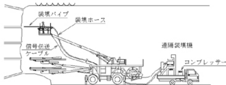
爆薬の遠隔装填システム概要図
