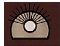
先進導坑からの事前補強
