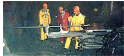
長孔削孔による探査
