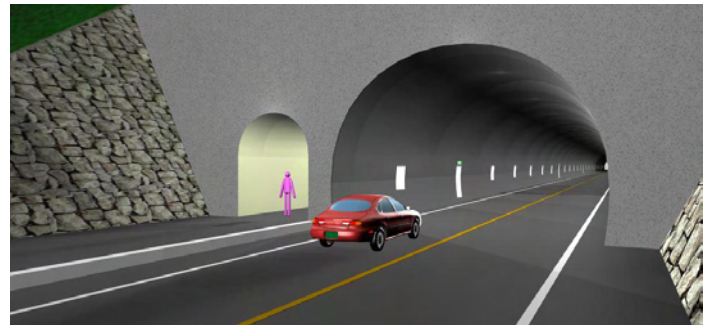
図 - 1 「活線隣接歩道増設工法」概念図
