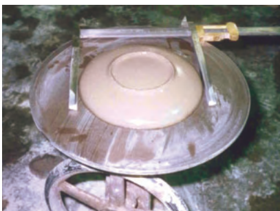
可塑性添加前のフロー Grout without plasticity
