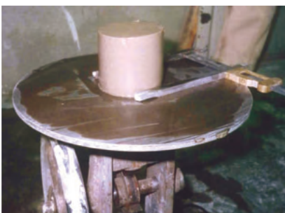
可塑性添加後のフロー Grout with plasticity
