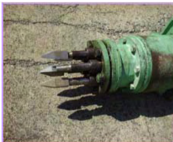
スパイクハンマーへの専用ビット取付け状況
