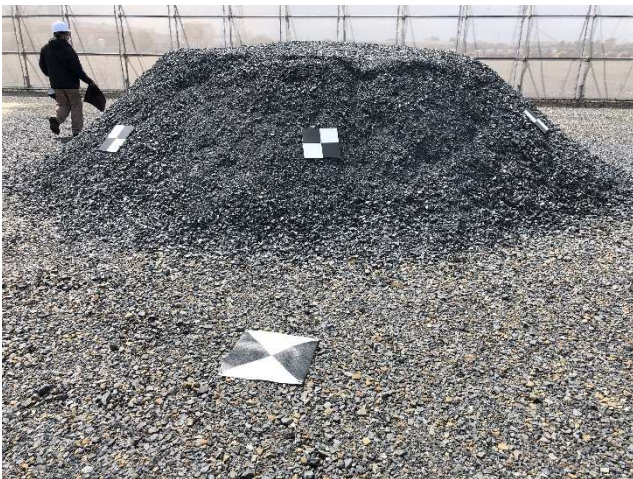
図3 計測対象に標定点を設置した例
