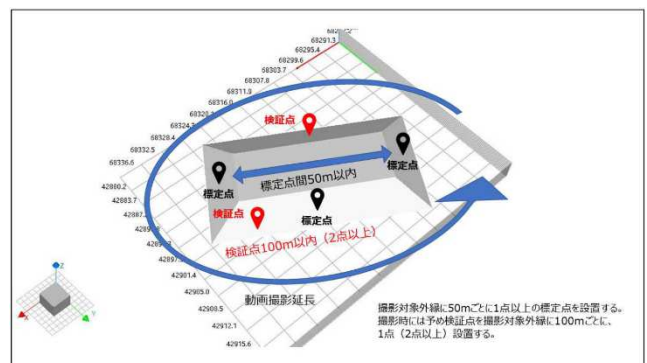
図4 国土交通省の要領案にある計測精度確認方法
