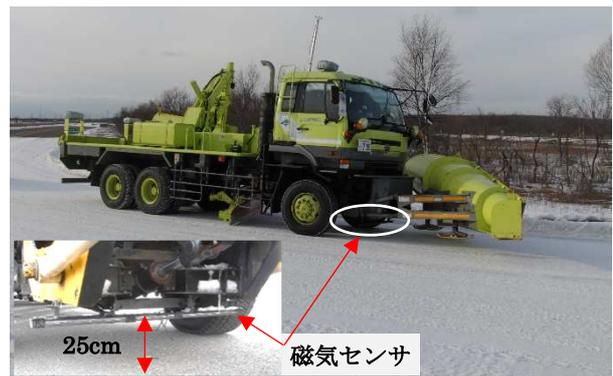
写真-3 磁気センサ設置状況
