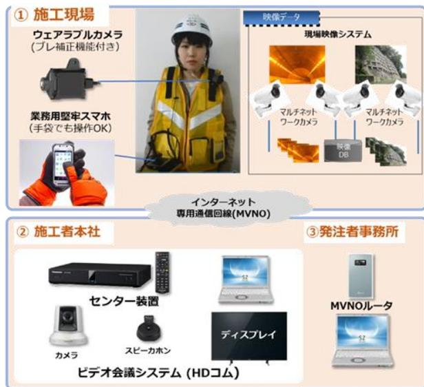
図-2 遠隔臨場システム構成
