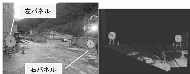
図-4 検証点設置状況(左)と3D点群データ(右)
